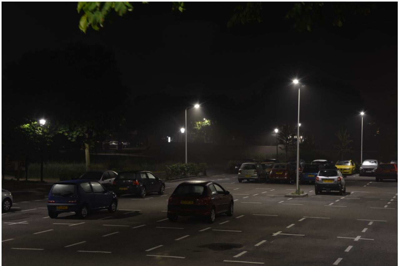
Foto: Palumbus, parkeerterrein; overdag in gebruik en in de nacht beperkt gebruikt. Het licht brandt wel de hele nacht, maar wordt gedimd tussen 00.00 en 06.00 uur tot 50% op het hele parkeerterrein.
